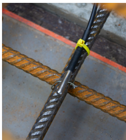
Abbildung 2: Montiertes digitales Thermoelement
